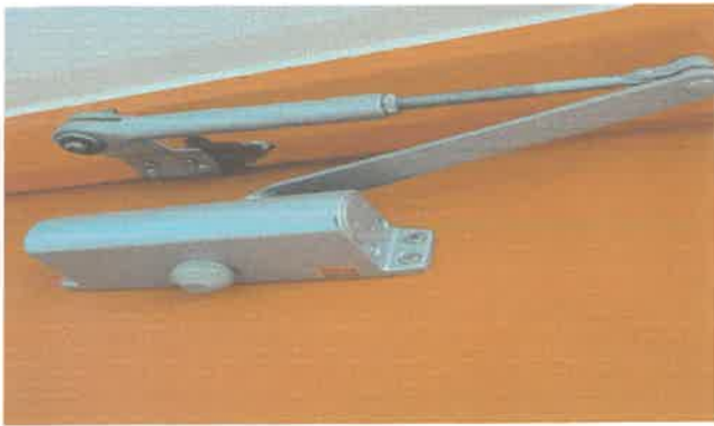
3층 원형계단 출입 방화문 클로저 재부착
